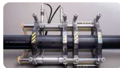
Fresare le parti da saldare e verificarne l'allineamento.
