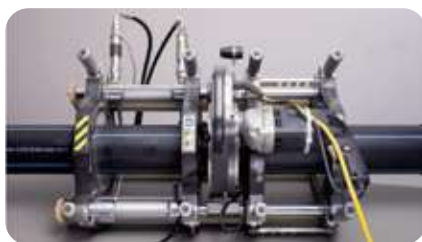
Fresare le parti da saldare e verificarne l'allineamento.
