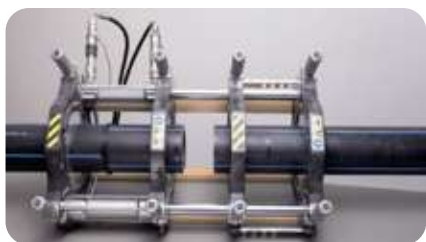
Posizionare gli elementi da saldare nella macchina.
